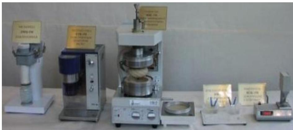
Рисунок 2 – Линия определения числа падения в зерне или муке
