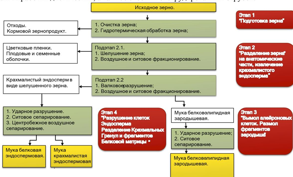
Рисунок 2 - Структурная схема производства белковых и углеводных компонентов зерна.
