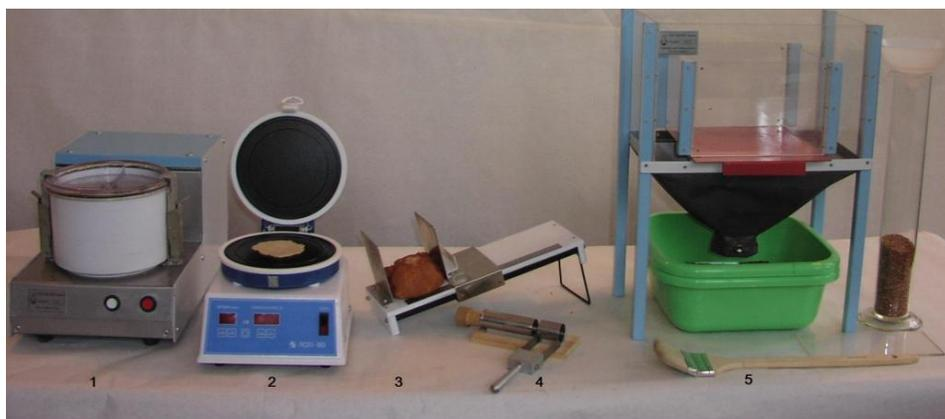
Рисунок 4 – Комплекс приборов и лабораторного оборудования для определения качества хлеба
